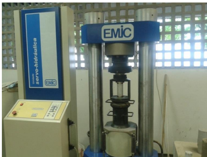
Figura 19 - Prensa universal – Ensaio de resistência à compressão axial.
