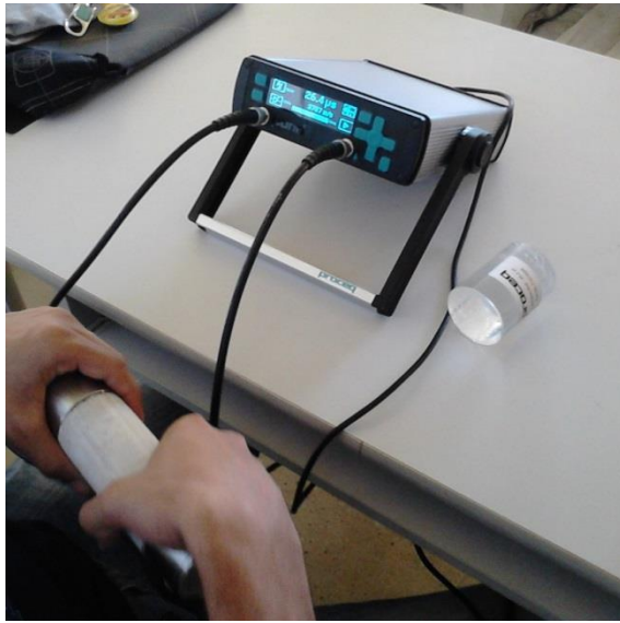
Figura 18 - Ensaio de velocidade de propagação de onda ultrassônica.
