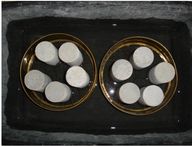
Figura 17 - Ensaio de absorção de água por capilaridade.
