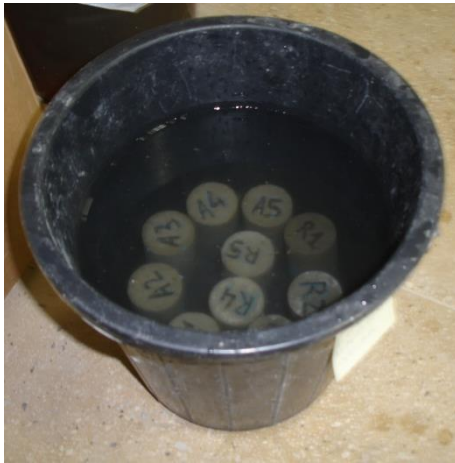
Figura 16 - Cura, em água, dos CPs.
