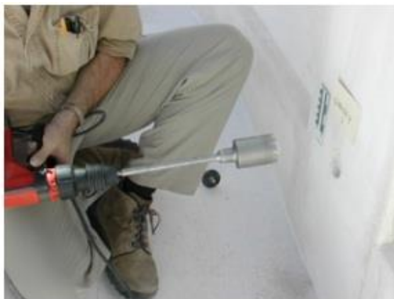
Figura 3 - Coleta de amostras de reboco à base de cal com mucilagem de cactos.
