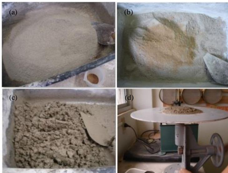
Figura 15 - (a) Cimento e areia misturados; (b) Incorporação do aditivo de cacto em pó; (c) Homogeneização da mistura após acréscimo da água; e (d) Determinação da consistência.
