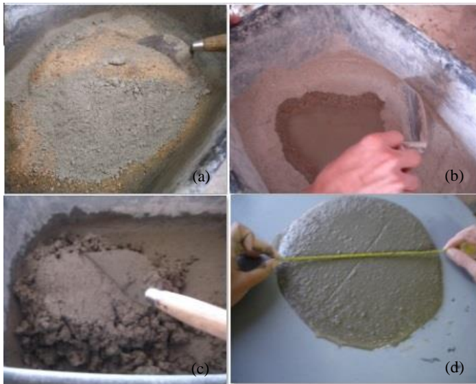
Figura 14 - (a) Mistura dos ingredientes secos; (b) Acréscimo de água; (c) Homogeneização dos componentes; e (d) Obtenção do índice de consistência.
